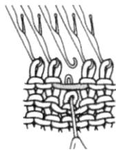
(2) Desenreda la punta caída, sosteniendo la puntada de abajo en la herramienta de transferencia.
