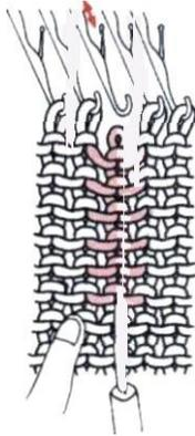
1 Empujar la aguja que se va a reformar a la posición D y luego volver a la posición B. Insertar una herramienta de taqués en la puntada 6 filas por debajo de la puntada en la aguja.
